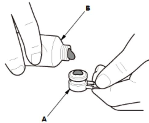
注意: 确保不要将硅基密封胶粘到插接器和开关的端子部分, 尤其是在手或手套上有硅基密封胶的情况下。
